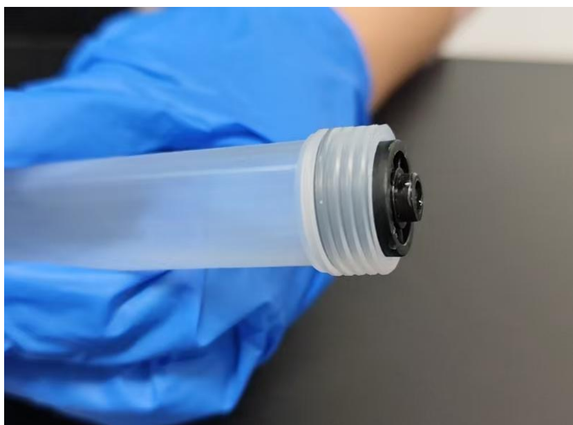
图 4 将密封塞按压进柱管
